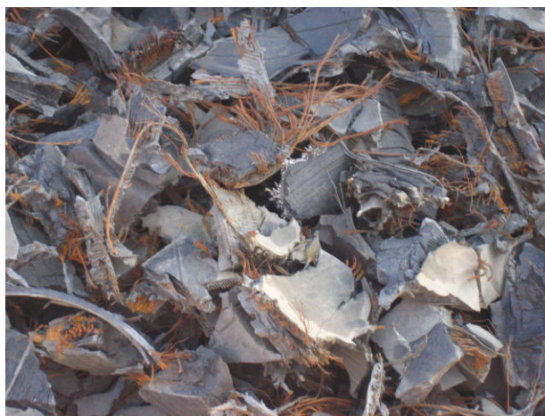
Figure 7 : Broyats de PL contenant de nombreuses barbules
