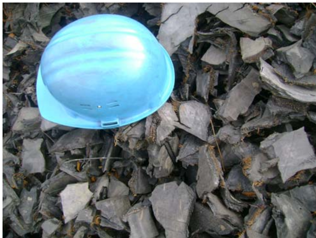
Figure 5 : Broyats de pneus PL
